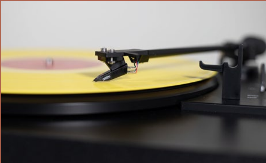
Beim Tonabnehmer des Pro-Ject A1 handelt es sich um einen Ortofon OM 10. Dieses kleine „Universalgenie“ läuft in Kombination mit dem superleichten Tonarm zu Höchstform auf
