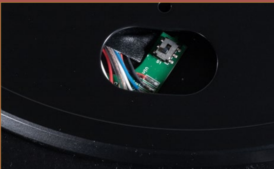
Hier ist der Schalter unter dem Plattenteller zu sehen, mit dem der interne Phono-Preamp deaktiviert oder aktiviert werden kann
